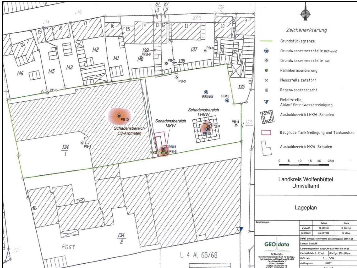
Abb.: Lageplan zur Übersicht der Schadensstellen, aufgestellt: GEO-data, Garbsen, 04.02.2010
